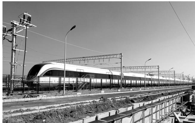
为大兴国际机场准备开通的“北京地铁新机场线”列车入场入轨，从3月15日开始，在北京城建集团二公司施工的01标6公里长的“样板段”上调试跑车，进行冷滑试验和动车热滑试验测试，此举标志着“北京地铁新机场线”与北京大兴国际机场，双双进入开通倒计时！正式运营后，列车设计将达到160公里/小时，比一般地铁时速快一倍。而北京城建集团二公司也有幸成为全国最快地铁线的修建者、创造者。
