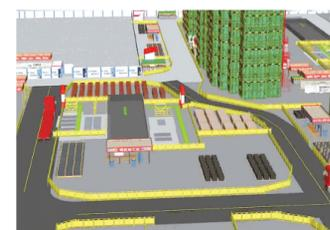
筑、结构、水暖电等全专业的施工组织、进度、资源、成本等信息整合，管线碰撞综合，进度动态管理，物料实时跟踪，招采适当提前，确保合理穿插施工达到优建目的。现场采用可视化与智能定位技术，基于远程安全指挥系统，实时监控人员与设备状况，加强应急响应机制及队伍建设，为安全优建提供信息化支撑。
