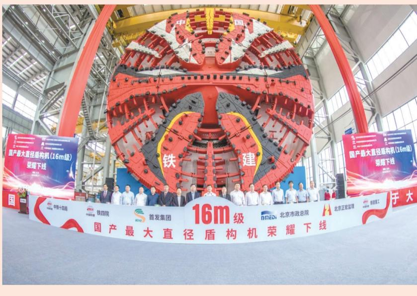
9月27日，一台最大开挖直径达16.07米的超大直径盾构机在长沙下线。这台“巨无霸”盾构机整机长150米，总重量4300吨，由中国铁建重工集团、中铁十四局集团联合研制，是我国迄今研制的最大直径盾构机，将参与北京东六环改造工程。
