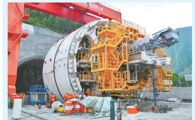
由中国制造的全世界最大直径全断面硬岩掘进机“高加索号”日前在格鲁吉亚组装机并投入使用。“高加索号”掘进机将主要应用于格鲁吉亚南北交通走廊科维谢提至科比公路隧道的施工, 由中铁隧道局集团和中铁装备集团联合研制, 完全采用中国设计、中国标准, 由中方独立制造。掘进机直径15.08米, 全长182米, 总重量3900吨, 最大推力2.26万吨, 总功率9900千瓦, 是目前全球最大直径全断面硬岩掘进机。(中国中铁隧道局集团)
